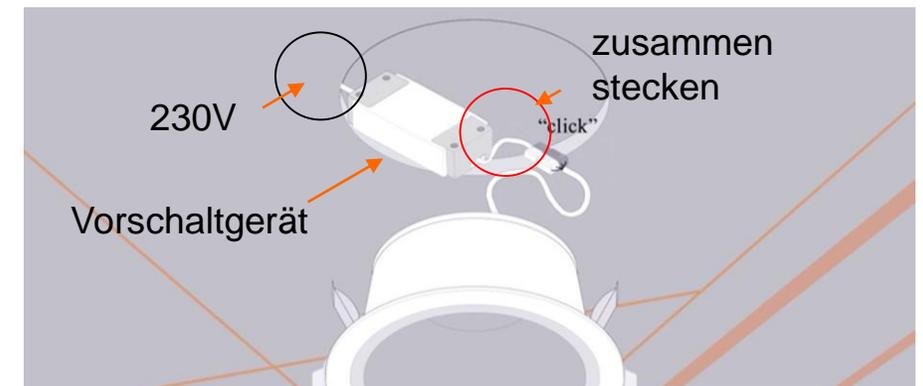
1. Das HCL Leuchtenvorschaltgerät an 230V anschließen
